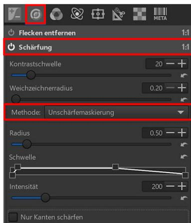
Die Effekte einiger Werkzeuge sind erst in der 1:1-Darstellung (100 %) und darüber hinaus richtig sichtbar. Das Werkzeug „Schärfung“ in der Registerkarte „Details“ gehört dazu.
